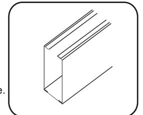
**Несущий профиль (стрингер)** традиционно производится из оцинкованной стали.
