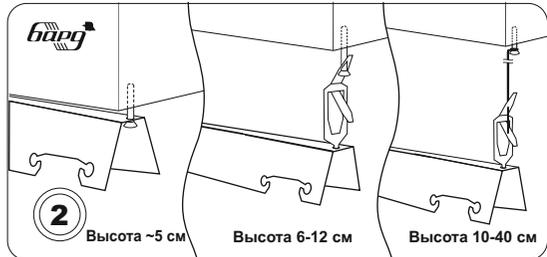
Варианты крепления стрингеров: длинным саморезом с зазором для регулировки высоты, на пружине и на пружине со спицей
