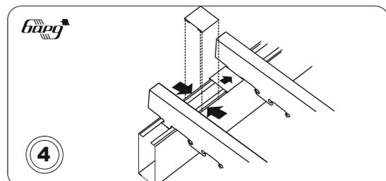
Установка фиксаторов на панели. Необходимо установить по одному фиксатору перед каждым стрингером. Немного сожмите панель сверху и установите фиксатор в пазы панели. Далее придвиньте фиксатор как можно ближе к стрингеру.
