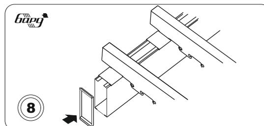
Установка заглушек. После установки панелей необходимо закрыть каждую панель с видимых сторон заглушками для обеспечения видимой цельности панели.
