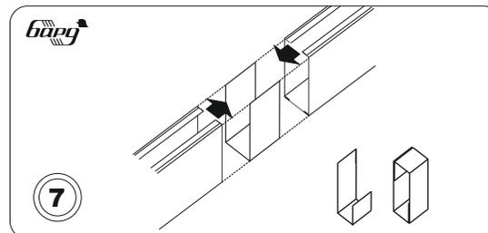
Соединение (наращивание) панелей. При необходимости состыковать две панели необходимо воспользоваться соединительным элементом. Он вставляется в стык двух панелей и находится внутри них. Для панелей большей высоты используется составной соединительный элемент (на рисунке справа).
