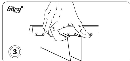
Установка первой панели. Панель предварительно укоротить на 3-5 мм от реального размера помещения. Панель с незначительным усилием (нажатием на края панели сверху) защелкнута на стрингере.
