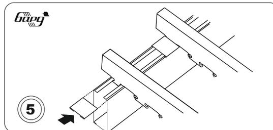
Установка фиксаторов на панели. Если стрингеров больше двух заранее позаботьтесь о том, чтобы фиксаторы были на панели перед установкой самой панели.
