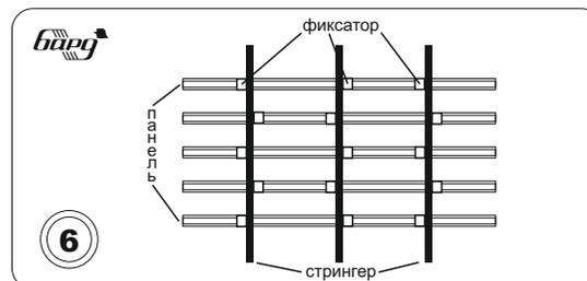
Общая схема установки фиксаторов на панели. У каждого стрингера должен находиться хотя бы один фиксатор. Фиксаторы около одного стрингера должны располагаться в шахматном порядке.
