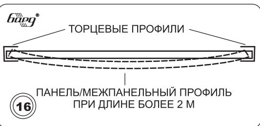
Установка последней панели в потолке. 1-й способ: при длине панели более 2 м, завести один край панели в торцевой профиль до упора, немного согнуть ее по плоскости вниз и вставить в торцевой профиль у противоположной стены.
